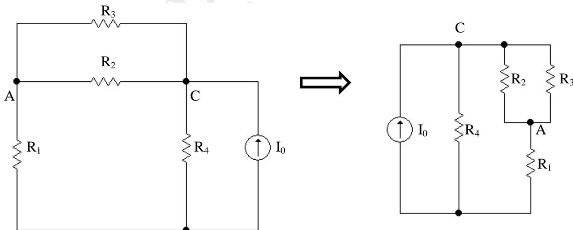
in cui la corrente che circola nel parallelo di  $R_2$  e  $R_3$  da C verso A risulta:
