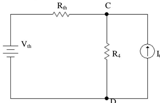
Quindi, per determinare  $V_{cd}$ , basta applicare il principio di sovrapposizione degli effetti che fornisce in ultimo:
