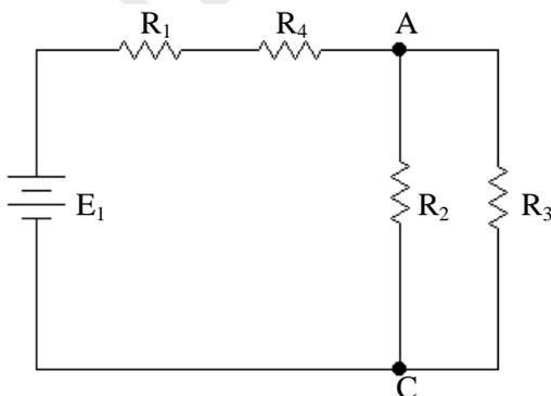
In cui  $R_1$  e  $R_4$  sono in serie e  $R_2$  e  $R_3$  sono in parallelo, per cui applicando la regola del partitore di tensione si ottiene:
