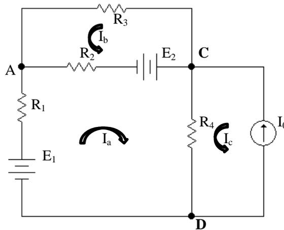
$$\text{Eq. Maglia } \mathbf{I_a} : R_2(I_a + I_b) - E_2 + R_4(I_a + I_c) - E_1 + R_1I_a = 0$$
